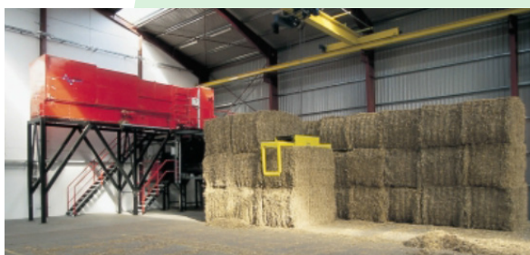
Фигура 4. Автоматичният кран в позиция на изчакване, докато контролната система "поискас" слама. Кранът повдига балата до шредера, където вратата се отваря автоматично. Балата се накъсва и сламата се подава в котела
