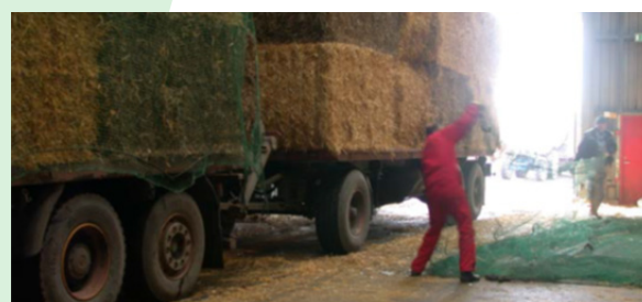
Фигура 7. При разтоварване на балите слама водачът и /или служителят в топлоцентралата отстраняват мрежата. Това ги излага на прах и спори от сламата.
